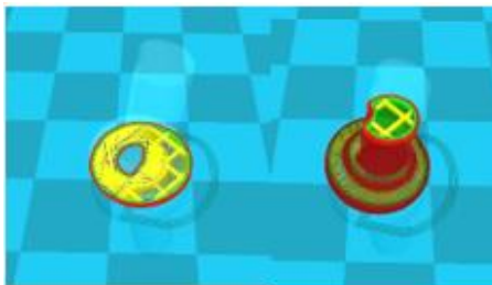
Рис. 2. Послойный просмотр 3D-модели клапана топливного насоса низкого давления в программе Cura
