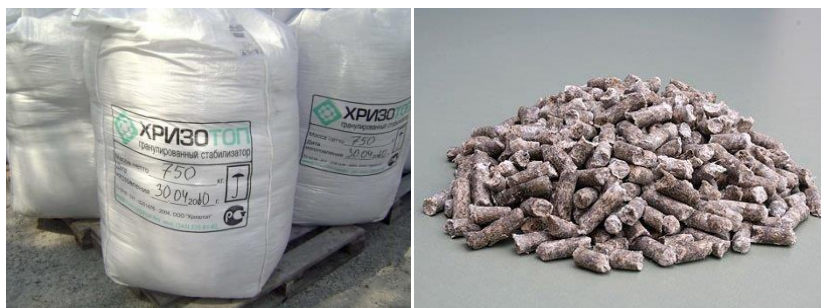
Рис. 2. Стабилизирующие добавки на основе хризотил-асбестовых волокон (хризотоп) [2]
