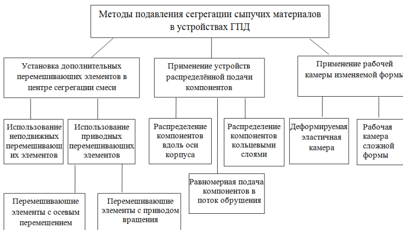
Рис. 1. Основные методы снижения сегрегации смеси в аппаратах гравитационно-пересыпного действия
