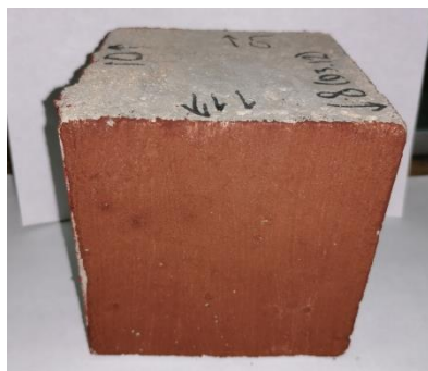
Рис. 1. Бетонный образец, окрашенный силикатной краской с гальваношламом в качестве пигмента
