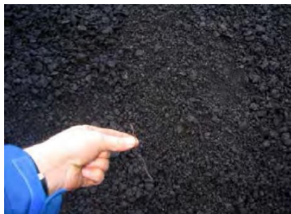
Рис. 1. Асфальтовый гранулят с геосинтетическими волокнами [5]
