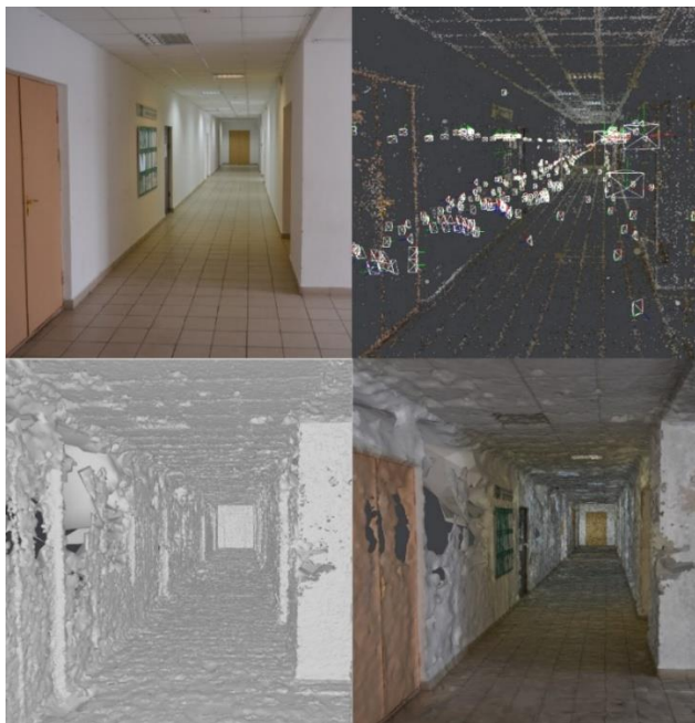
Рис. 1. Процесс получения модели из фотографии
